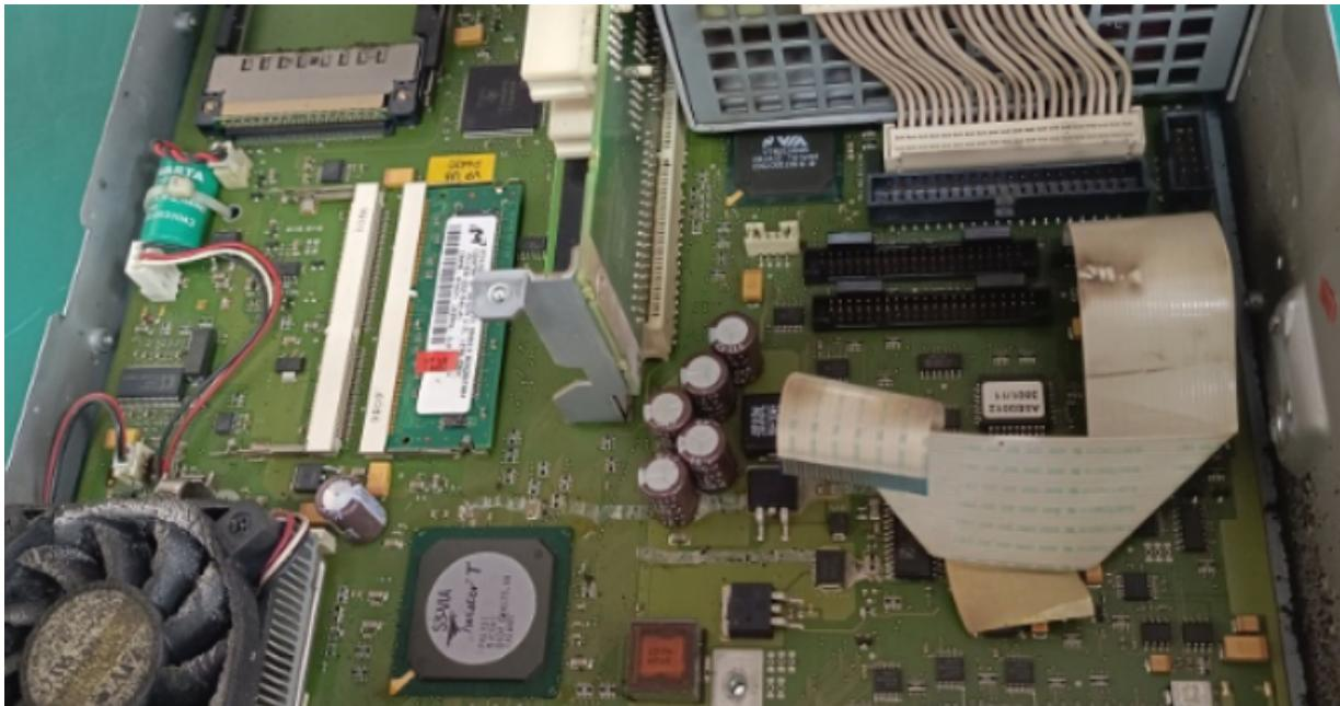
电路板可称为印刷线路板或印刷电路板，英文名称为 PrintedCircuitBoard PCB 和 FlexiblePrintedCircuitboard FPC 线路板 FPC 线路板又称柔性线路板柔性电路板是以聚酰亚胺或聚酯薄膜为基材制成的一种具有高度可靠性，较好的可挠性印刷电路板。具有配线密度高、重量轻、厚度薄、弯折性好的特点。）和软硬结合板 reechas Softandhardcombinationplate -FPC 与 PCB 的诞生与发展，催生了软硬结合板这一新产品。因此，软硬结合板，就是柔性线路板与硬性线路板，经过压合等工序，按相关工艺要求组合在一起，形成的具有 FPC 特性与 PCB 特性的线路板。
