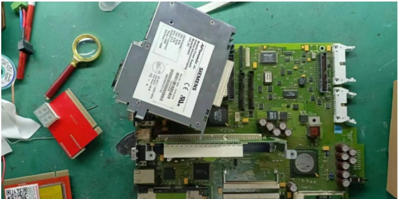
若阻值正常后,再用万用表测量板上的阻容器件,二、三极管,场效应管,以及拨段开关等元器件.其目的就是首先要确保被测量过的元器件是正常的.能用一般测试工具(如万用表等)解决的问题,就不要把它复杂化.先易后难:为提高测试效果,在对电路板进行在线功能测试前,应对被修板做一些技术处理,以尽量削弱各种干扰对测试过程中带来的影响.具体措施如下:1. 采用排除法对器件进行测试对器件进行在线测试或比较测试过程中,凡是测试通过(或比较正常)的器件,请直接确认测试结果,给以记录.对测试未通过(或比较超差)的,可再测试一遍.若还是未通过,也可先确认测试结果.这样一直测试下去,直到将板上的器件测试(或比较)完.然后再来处理那些未通过测试(或比较超差)的器件。湖北安装进口电路板维修以客为尊进口电路板维修报价。欢迎咨询上海枫逸电气自动化有限公司。
